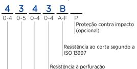
Resistência ao rasgo Resistência ao corte por golpes
